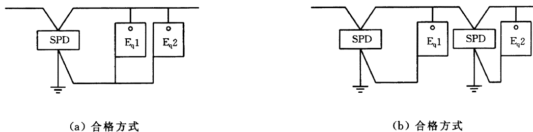
图 C5 单口 SPD 的安装方式(合格方式)
